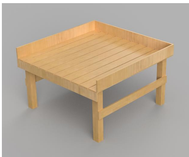
Ryc. 2. Projekt stołu badawczego, na którym znajduje się analizowany zielony dach (oprac. własne: M. Biela).
