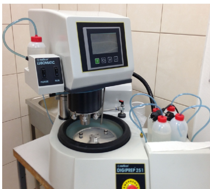
AUTOMATYCZNA SZLIFIERKO-POLERKA DIGIPREP 251 WYPOSAŻONA W AUTOMATYCZNY DOZOWNIK PŁYNÓW POLERSKICH DIOT
